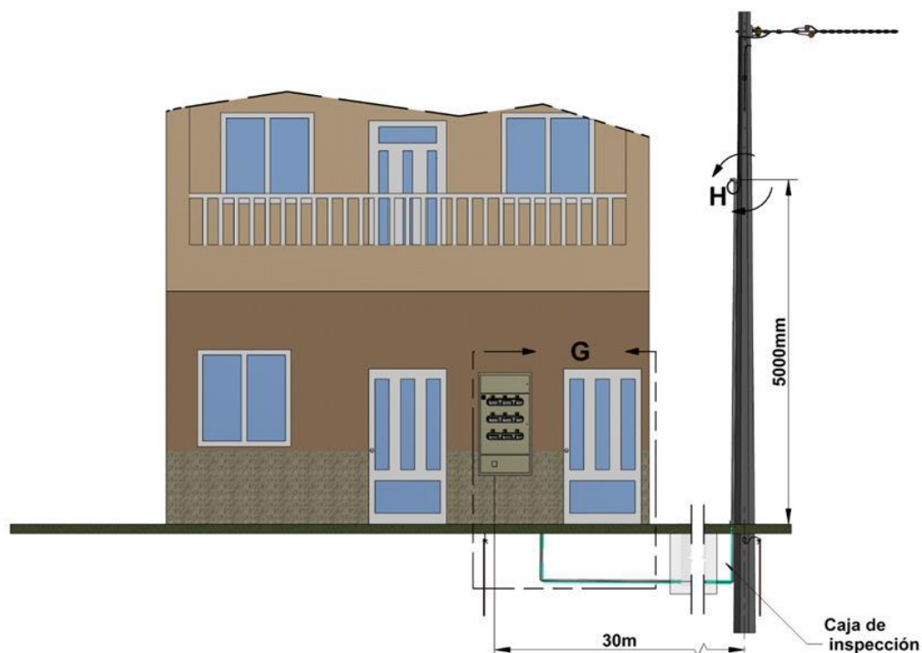
Figura 8. Acometida múltiple. Tablero para múltiples medidores de energía.
