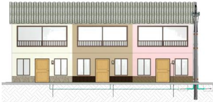
Figura 7. Canalizaciones subterráneas – Acometida subterránea.
